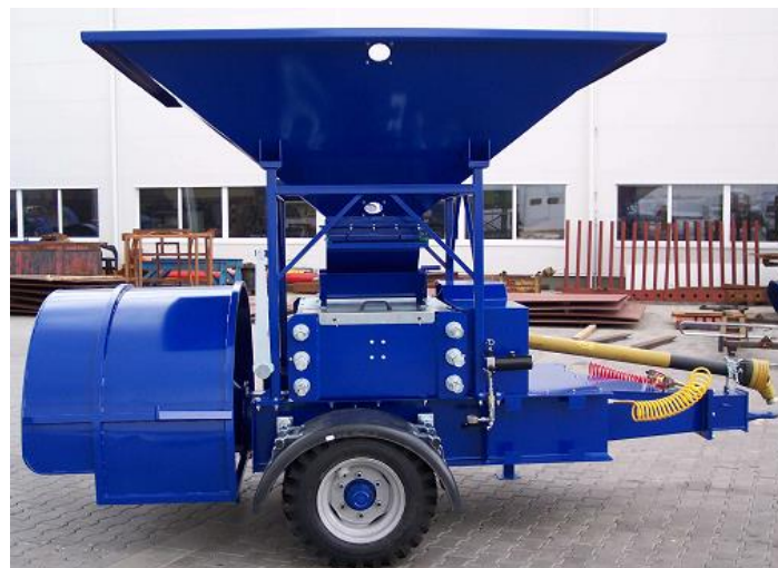
Рисунок 2.7 - Загальний вигляд машини для плющення та пакування вологого зернофуражу «Grinder bagger» GB 6
