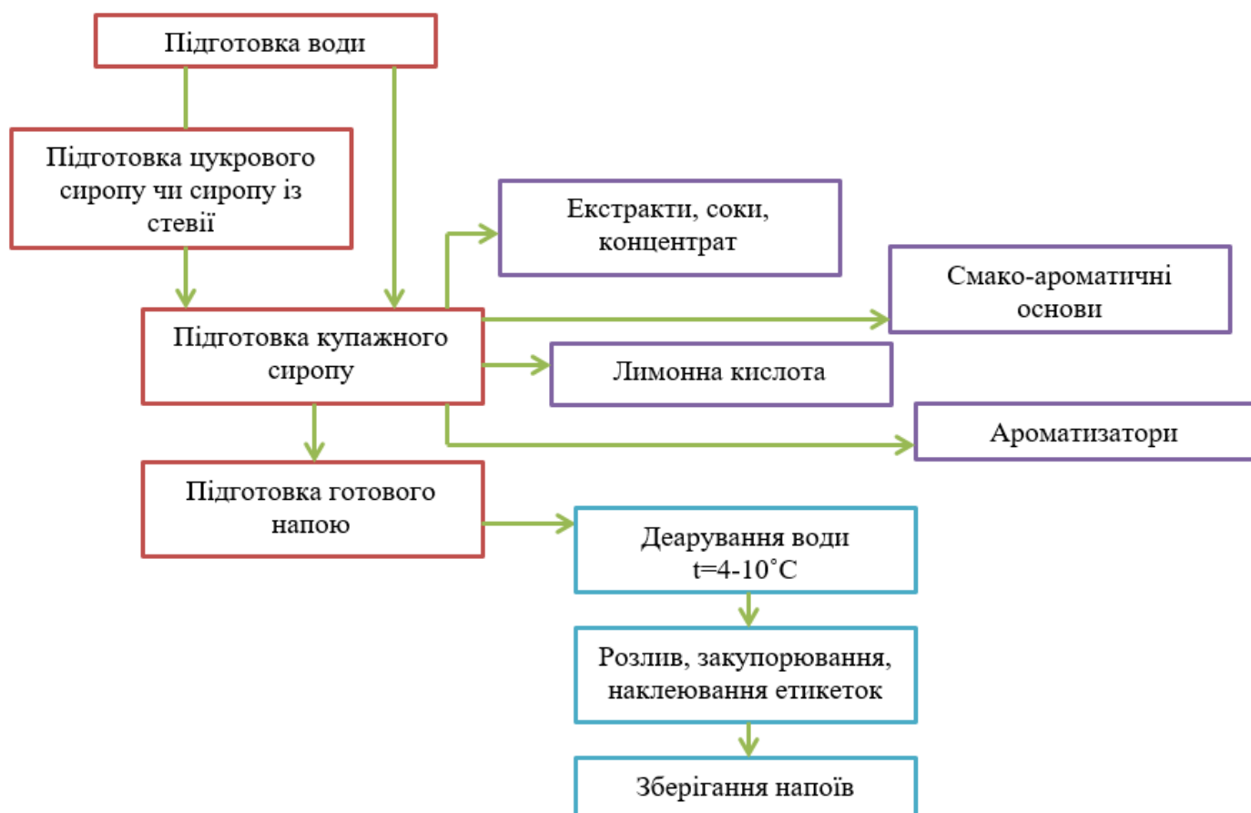
Рисунок 4.1 – Технологічна схема виробництва напоїв
