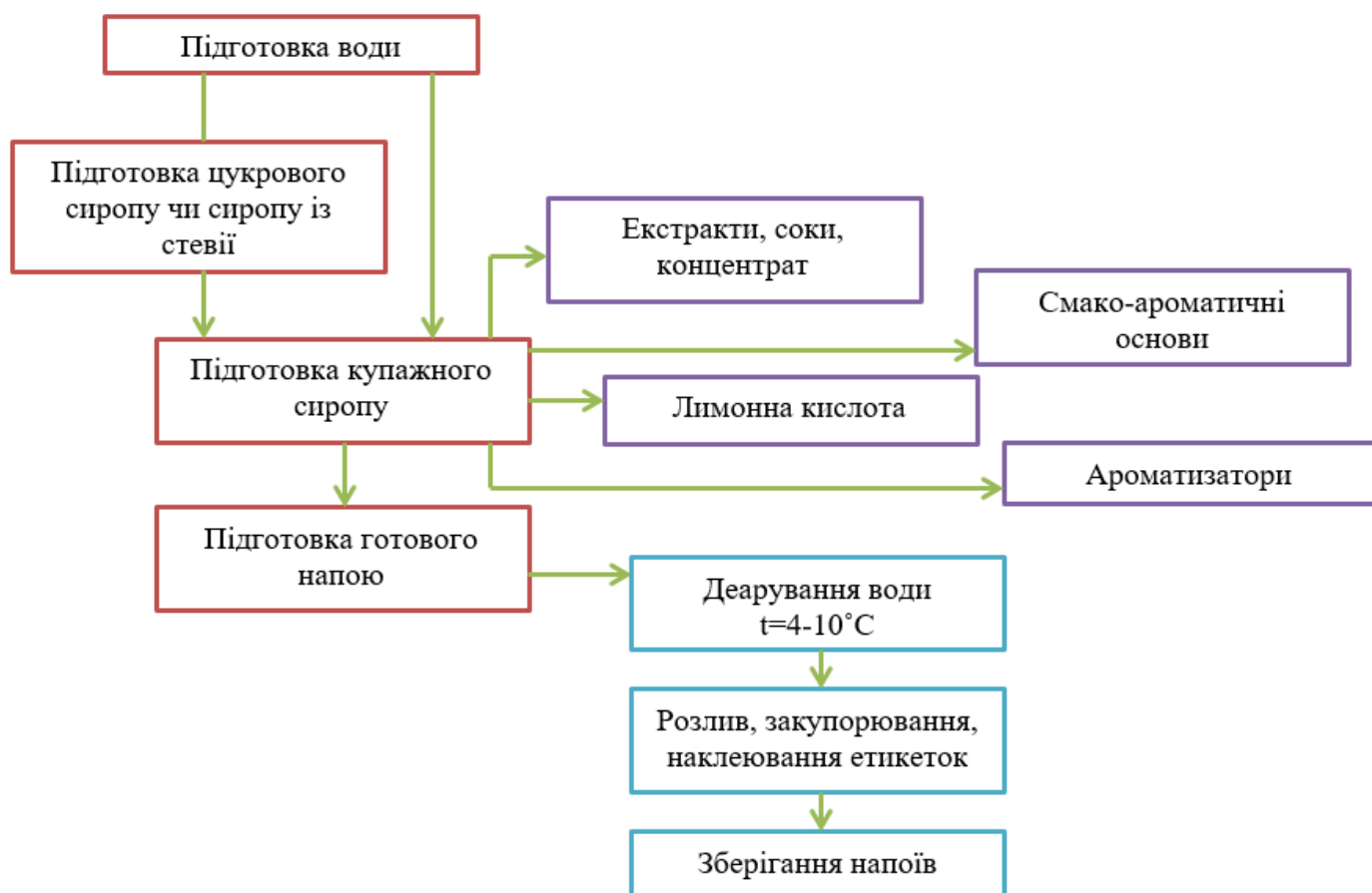
Рисунок 4.1 – Технологічна схема виробництва напоїв
