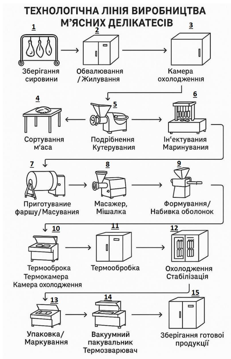
Рисунок 2.2 – Технологічна лінія виробництва м'ясних делікатесів
