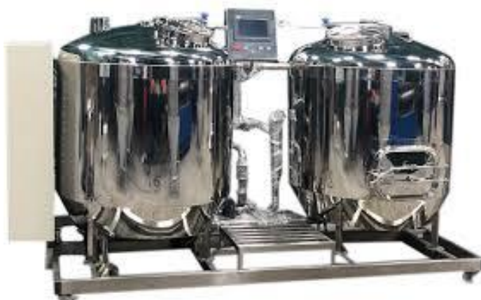
Рисунок 2.8 - Двох поверхнева пивоварня [48]
