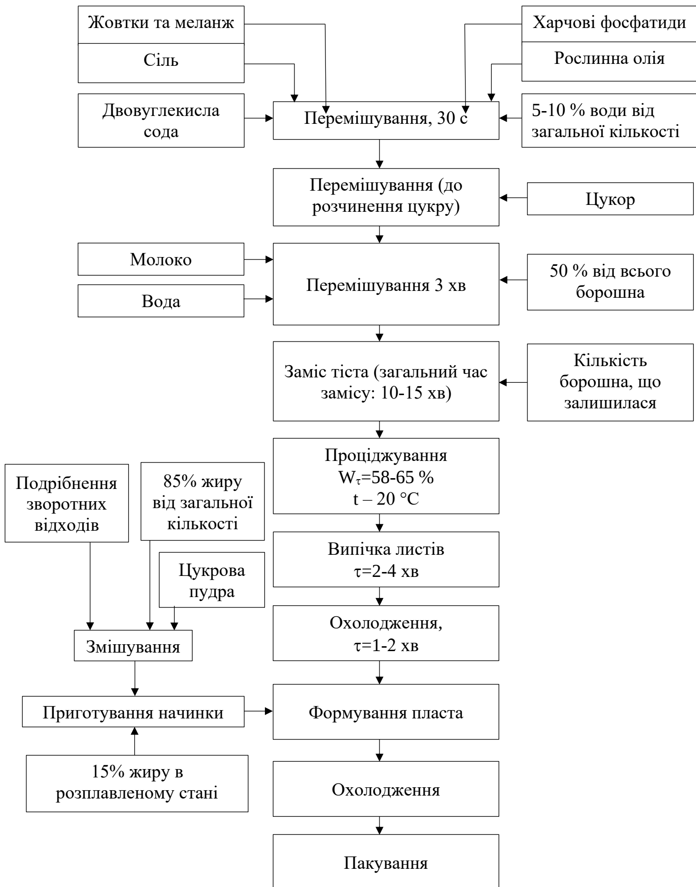
Рисунок 1.1 – Схема виробництва вафель за традиційною технологією
