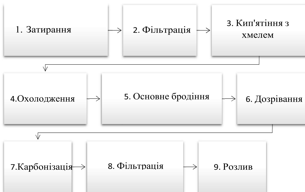
Рисунок 1.5 – Процес виробництва пива у ТОВ «Перший Дніпропетровський пивзавод»
