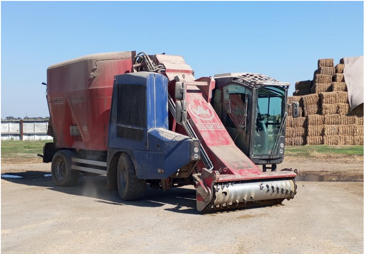
Рис. 3.7 Кормозмішувач самохідний фірми «Siloking» об'ємом 27м 3
