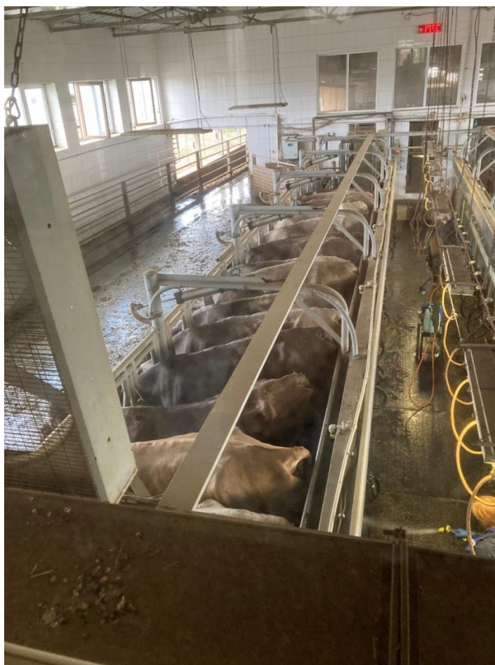
Рис. 1. Фронтальна огорожа для фіксації 20 корів та притискання їх до задньої обмежувальної стінки установки
