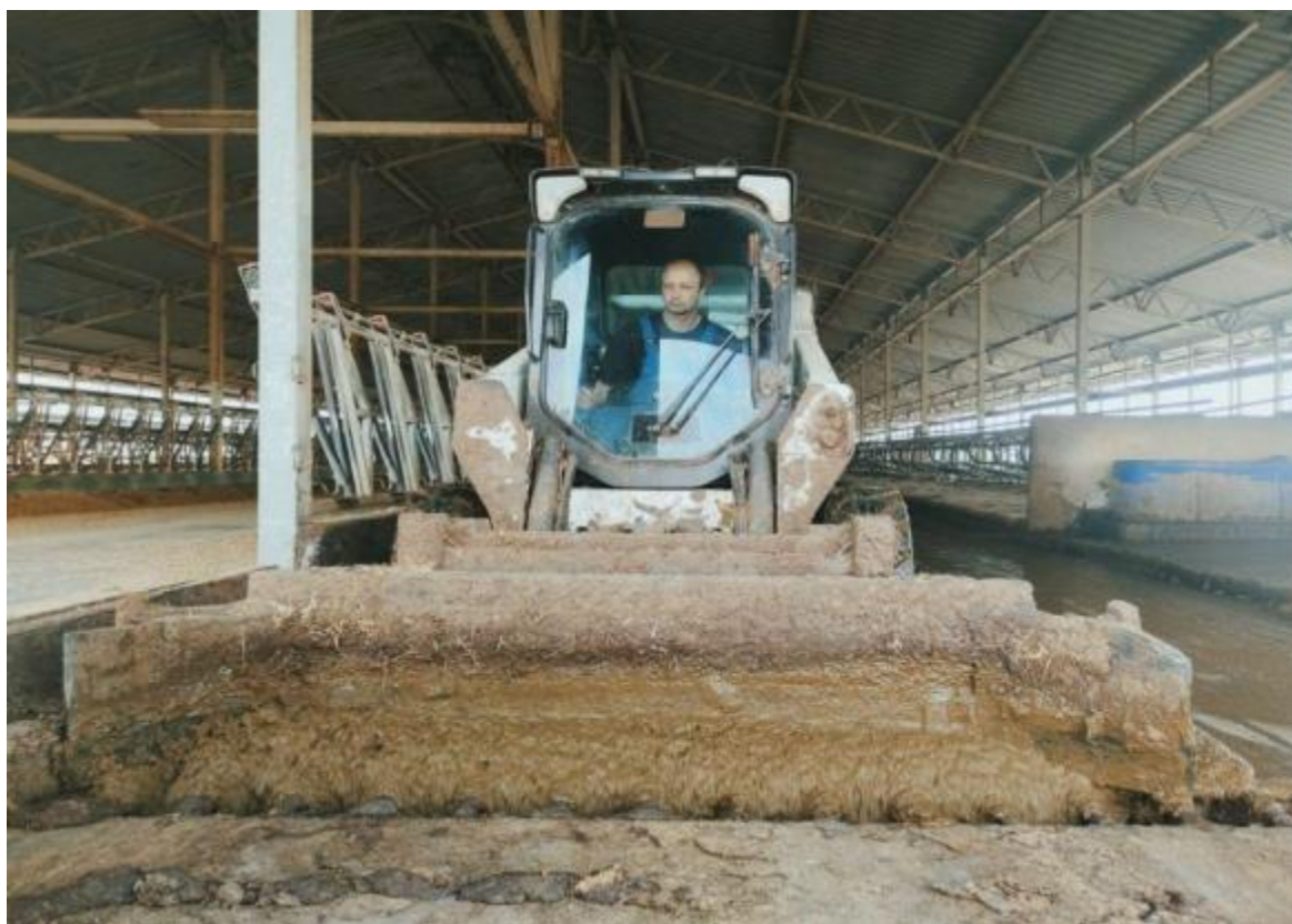
Рис. 3.5 Видалення гною в корівнику за допомогою Бобкету
