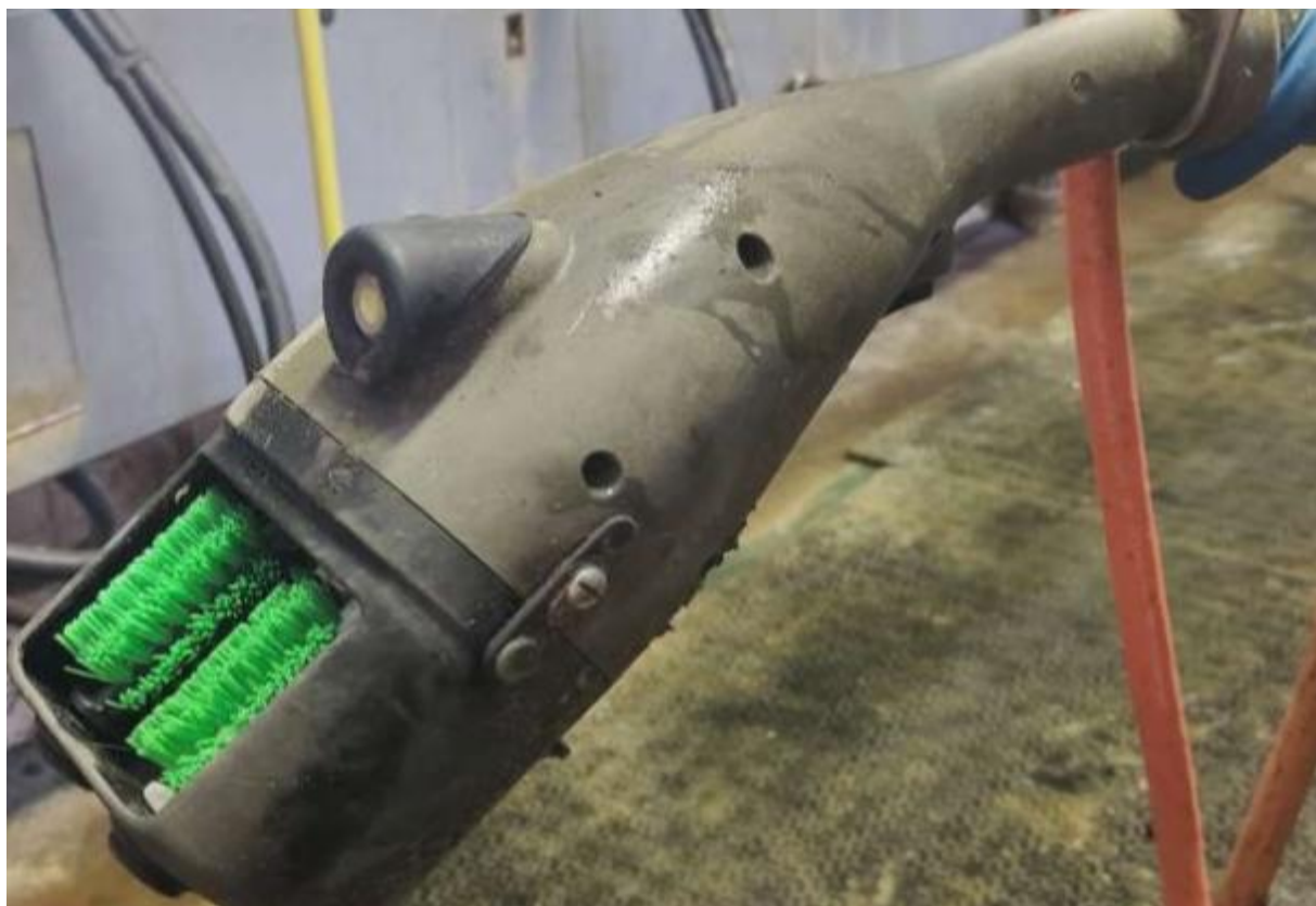
Рис. 3.8 Щітка скрубер для підготовки вим'я корови до доїння
