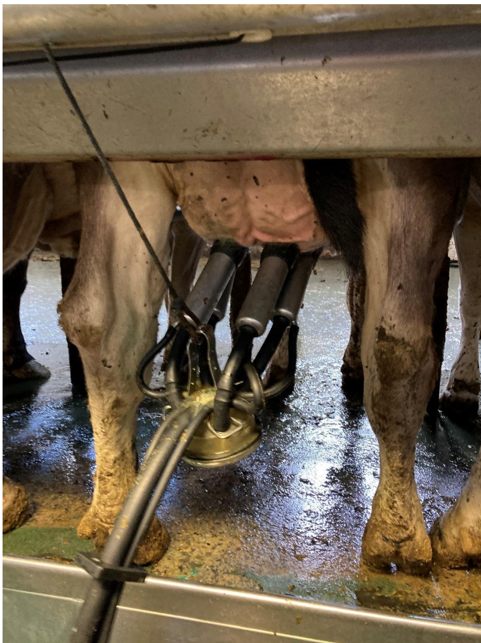
Рис. 3. Автоматичне відключення доїльного апарату
