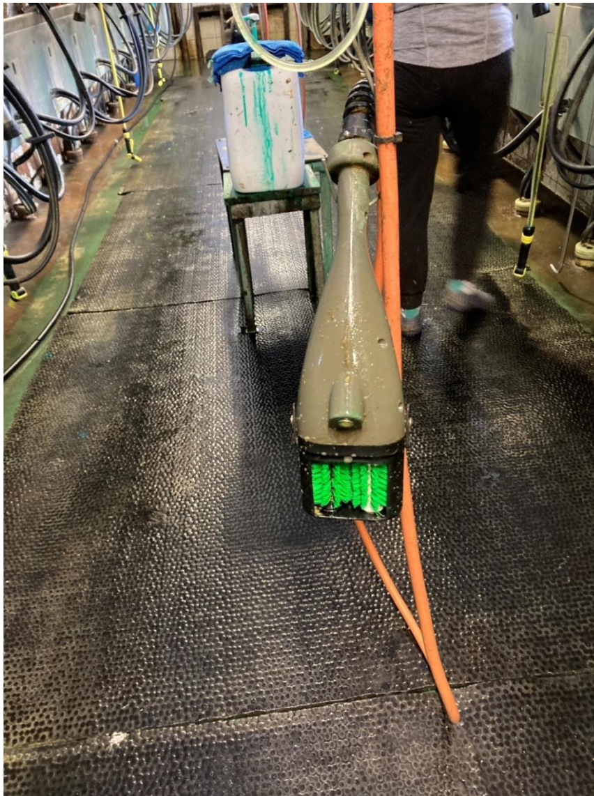
Рис. 1. Ручний напіваавтоматичний апарат для обмивання і масажу дійок вимені корів
