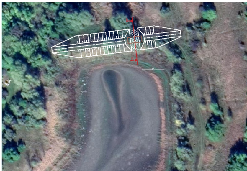
Рисунок 4.6 – Схема влаштування прорану греблі ставка № 24
