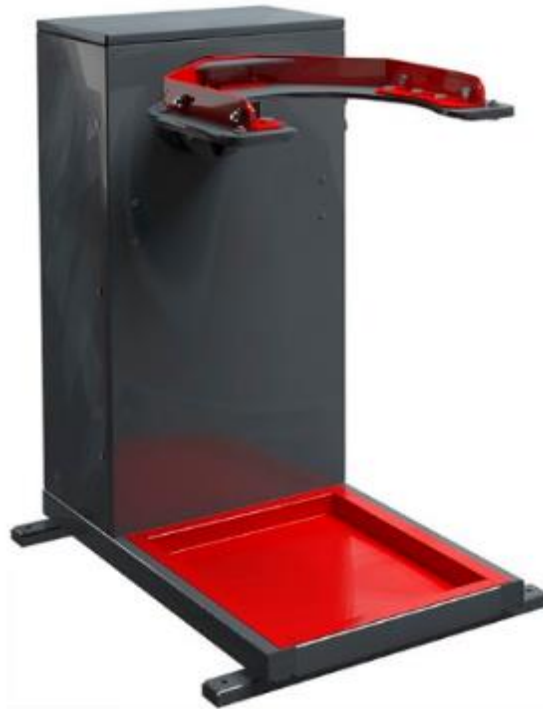
Рисунок 3.2 - Універсальний стенд для ремонту редукторів КрАЗ, МАЗ, КамАЗ та інших вантажівок
