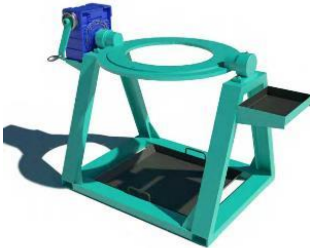
Рисунок 3.1 - Стенд-кантувач для редукторів БелАЗ
