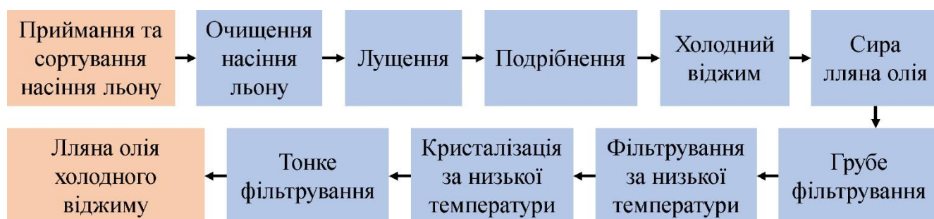
Рисунок 2.2 – Схема процесу виробництва лляної олії методом холодного пресування
