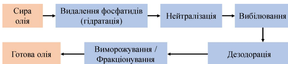
Рисунок 2.3 – Схема процесу виробництва лляної олії методом екстракції та рафінації лляної олії
