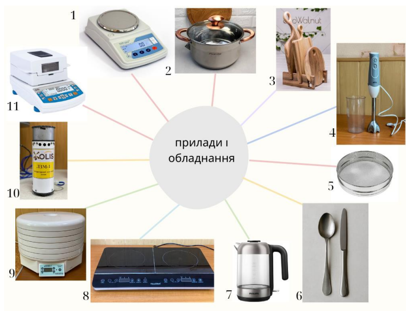
Рисунок 2.2 – Прилади і обладнання для виготовлення дослідних зразків супів-пюре швидкого приготування: 1 – ваги лабораторні ТВЕ-0,3-0,01, 2, 3 – посуд кухонний, 4 – блендер Braun MQ 535 Sauce, 5 – сито, 6 – столові прибори, 7 – чайник електричний Philips, 8 – плита індукційна HausMark, 9 – сушарка Ezidri ultra fd1000 digital, 10 – лабораторний млинок ЛЗМ-1, 11 – ваги-вологомір «Radwag» MA 50/1.R
