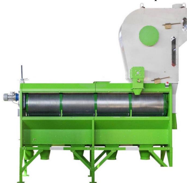
Рис.2.4 – Застосування тихохідних решіт на прикладі зерноочисної машини «Луч» [4]
