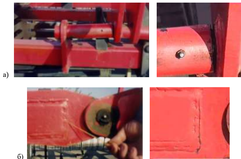
Рис. 2. Локальні руйнування та тріщини в зварних швах центральної рами культиватора: а) трубчаста ось в механізмі підйому; б) передня опора
