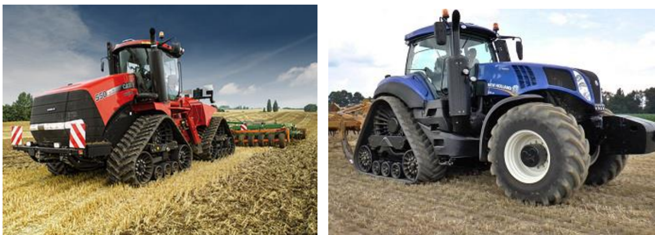
Рис. 2.6. Гусеничний та напівгусеничний хід трактора [11]
