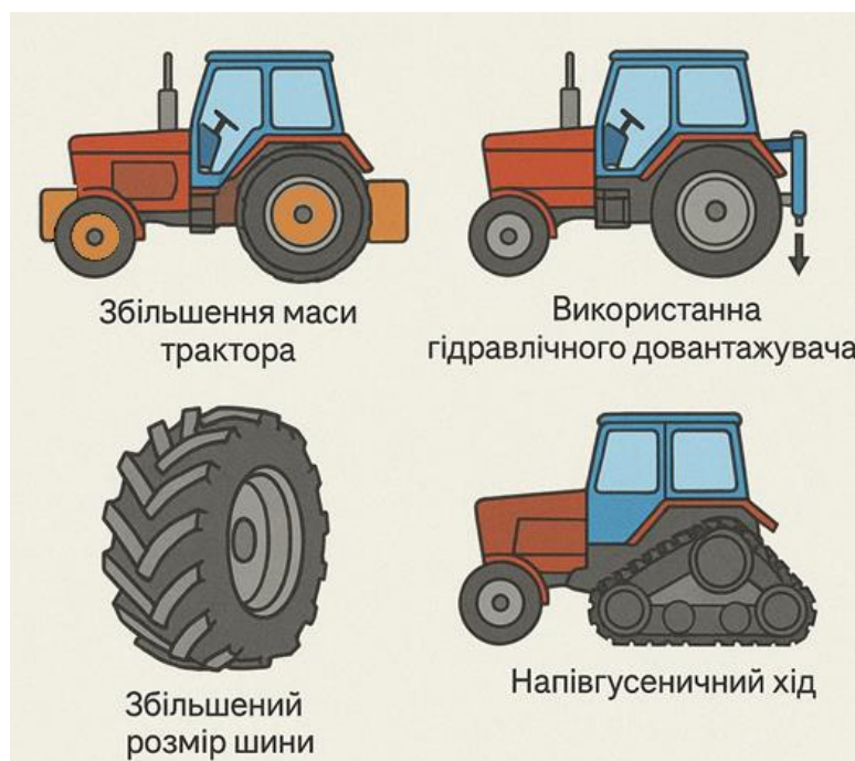
Рис. 2.3. Основні способи підвищення зчіпної ваги трактора та зчеплення колісних рушіїв
