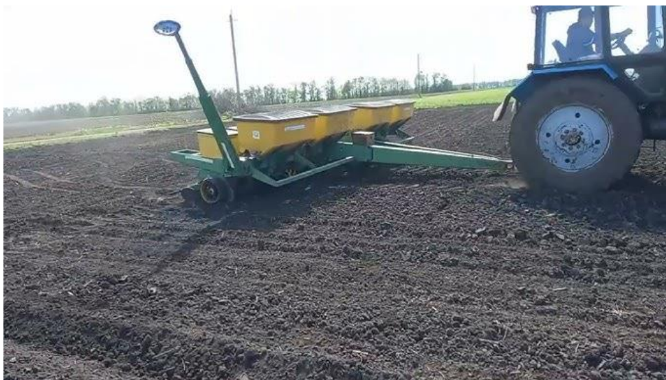
Рис. 1.2. Посів просапних культур сівалкою точного висіву John Deere 1780 в агрегаті з трактором ЮМЗ-8040
