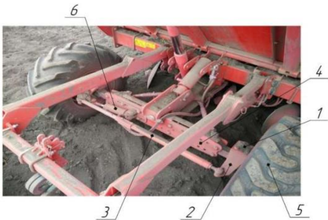
Рис. 2.9. Позиціонування картоплесаджалки Grimme з використанням підрулюючих коліс
