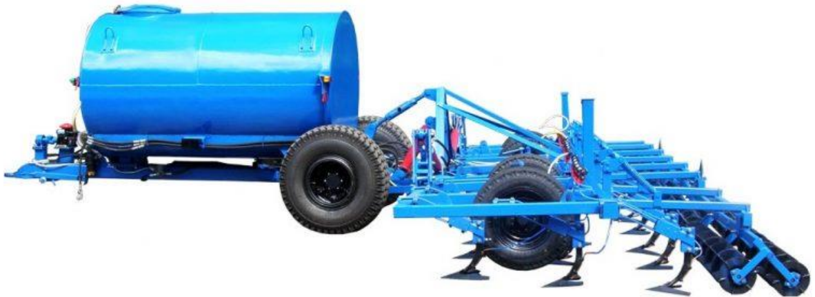
Рисунок 2.2 – Агрегат для внесення рідких мінеральних добрив АВА-8 (Уманьферммаш)
