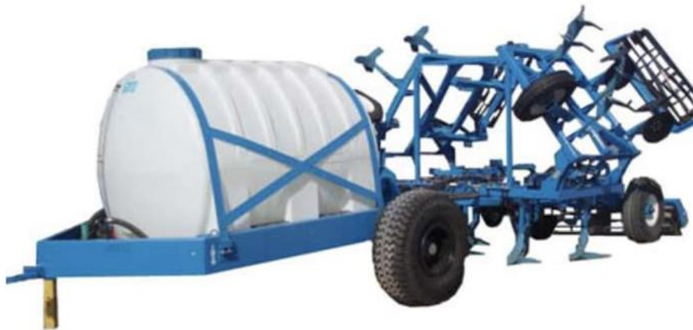
Рисунок 2.3 – Культиватор КУ-6,2А з обладнання для внесення КАС (Богуславська сільгосптехніка)
