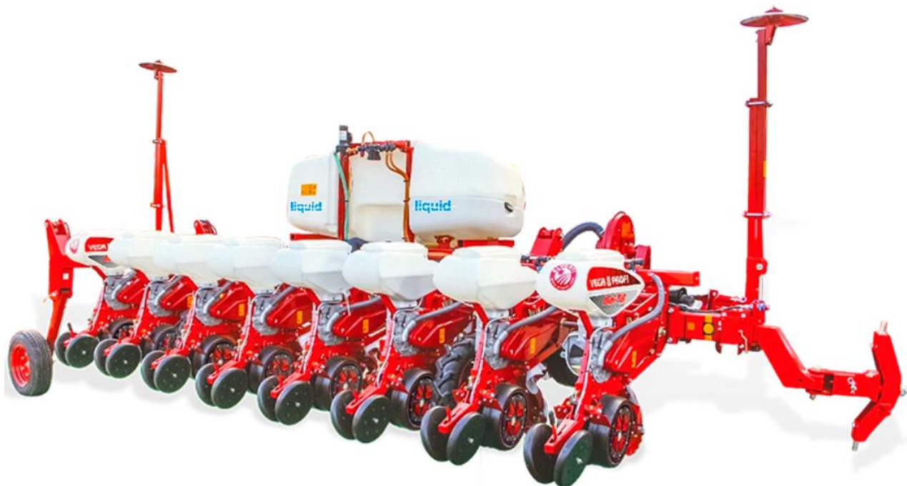
Рисунок 2.5 – Сівалка Vega 8 Profi з пристосуванням для внесення РМД (Elvorti)
