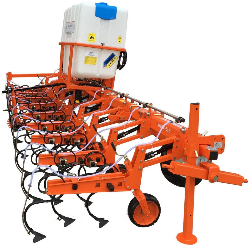
Рисунок 2.4 – Культиватор КРН-5,6 з обладнання для внесення КАС
