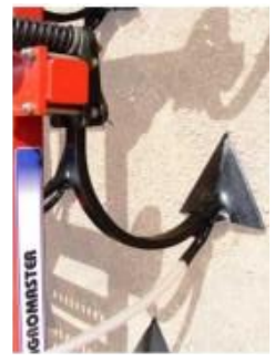
Сошник ББЗ сівалки - культиватора Salford: 1 - стрільчаста лапа; 2 – велитель ББЗ.
