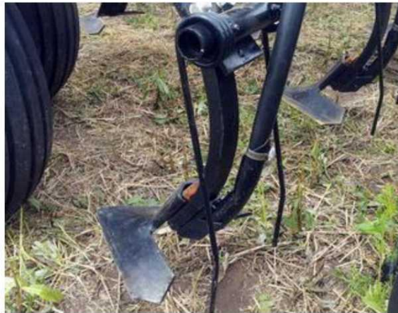
Рис. 3.13. - Сошник культиваторних сівалок Rostselmash
