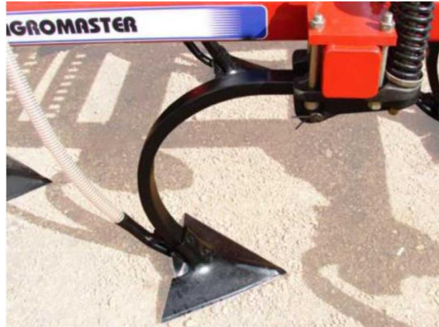
Рис.3.8. - Сошник посівного комплексу Agromaster
