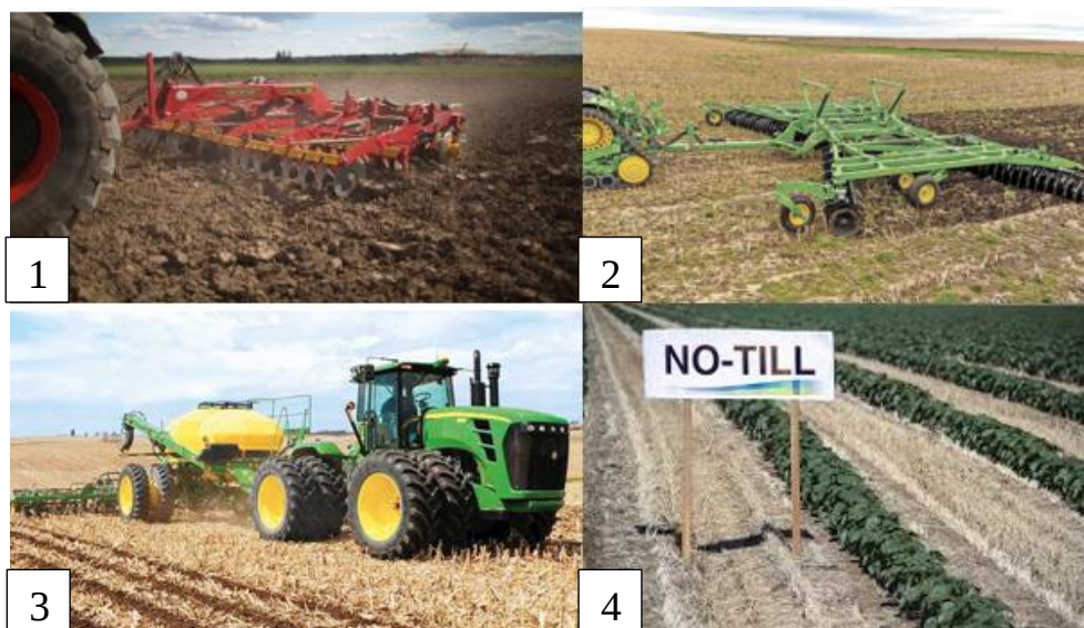
Рис. 2.1. – Види обробки ґрунту: 1 – Традиційна обробка; 2 - Mini-till; 3 - Strip-till; 4 - No-till
