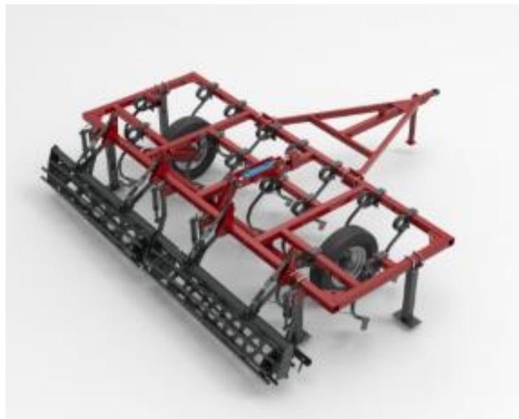
Рис. 2.5. – Культиватор причіпний КПС-4
