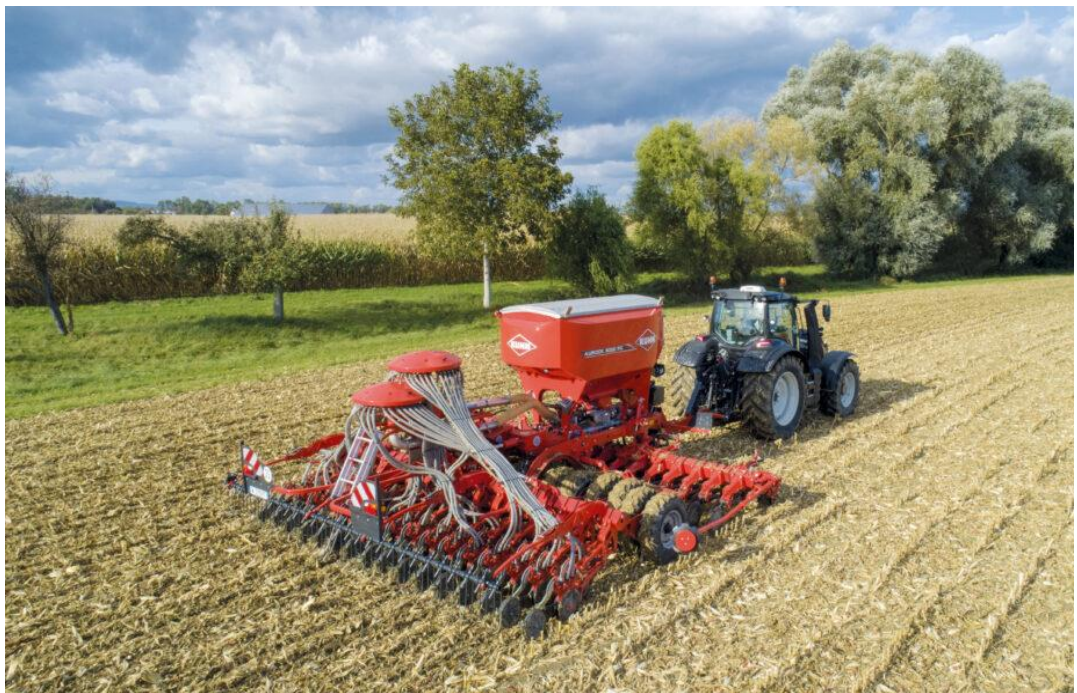
Рисунок 3.16 – Посівний комплекс для зернових культур за технологією min-till або no-till AUROCK 6000 RC фірми KUHN
