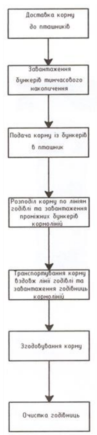
Рисунок 2.1 – Загальна технологічна схема процесу роздавання кормів птиці
