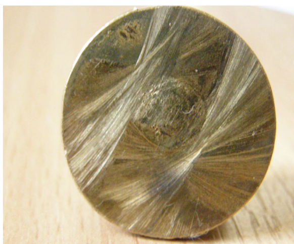
Рисунок 10 – Повне зношення кільцевої опори п'яти з завальцюванням отвору гідростатичного підшипника
