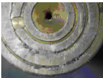
Рисунок 8 – Загальний вид зношення кільцевої опори п'яти
