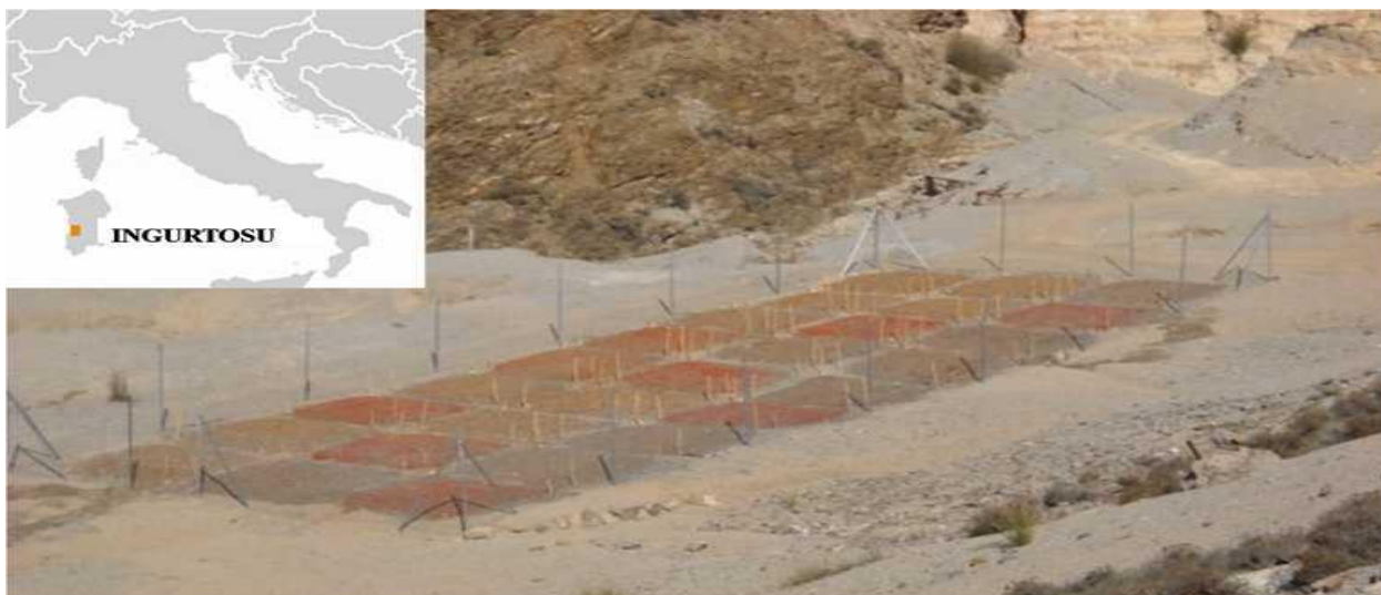
Рис.1.10. Дослідна ділянка з варіантами рекультивації на шахті Інгуртосу(Сардінія)
