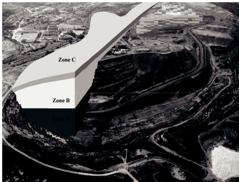
Рис. 1.12. Схематичне зображення заповнення кар'єру Ліхтенберг
