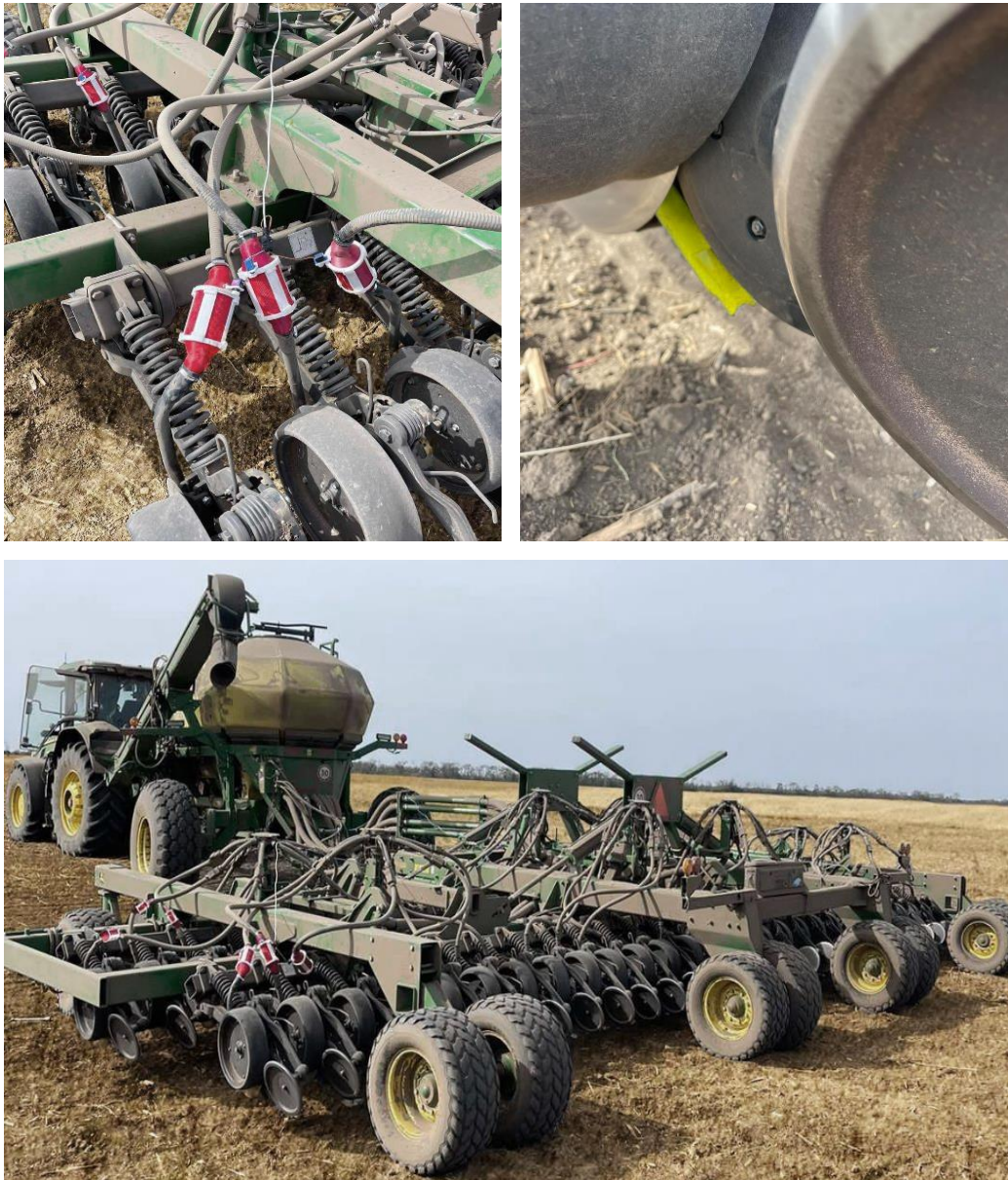
Рис. 1. Експериментальний зразок секції пневматичної зернової сівалки точного висіву на базі John Deere 90 Series
