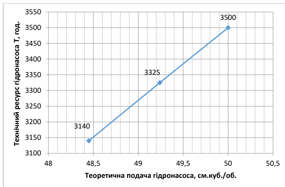
Рисунок 2 – Залежність технічного ресурсу насоса НШ-50-2А від його теоретичної подачі
