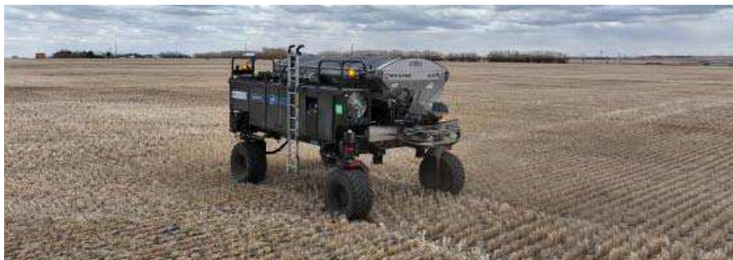
Рисунок 1 – Безпілотна мобільна автономна платформа: агроробот OMNiPower
