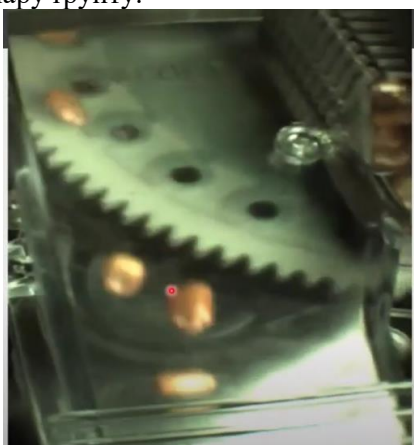
Рис. 2.8. Несанкціонований і ранній відрив насінин від отворів висівного апарату через наявність вібрації
