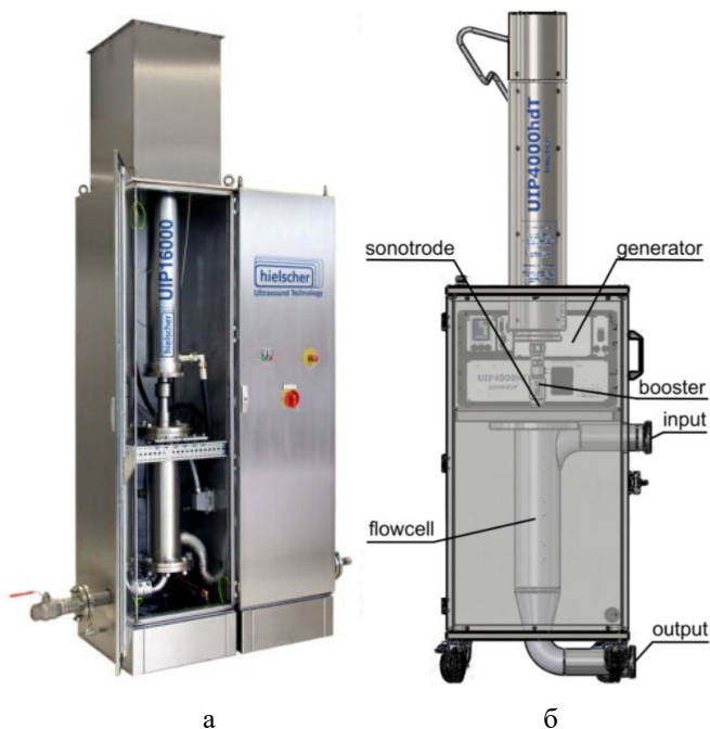
Рис.10. Установки ультразвукової обробки молочної продукції: а) промисловий ультразвуковий гомогенізатор UIP16000 для внутрішньої пастеризації харчових продуктів і напоїв; б) ультразвукова установка UIP4000HDT для нетермічної внутрішньої пастеризації харчових продуктів (наприклад, молочних продуктів, молока, соків, рідких яєць, напоїв) [13]
