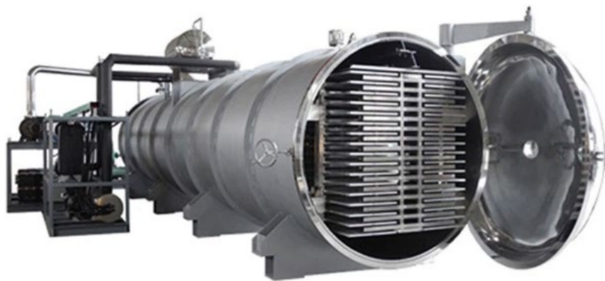
Рис. 33. Сублімаційна сушарка для молока – ліофілізатор [35]
