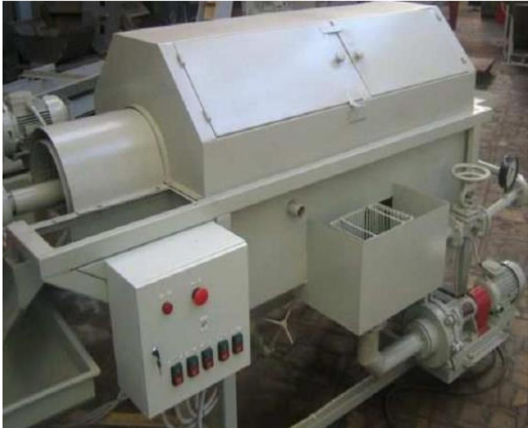
Рисунок 1.11 – Мийна машина барабанного типу з каменевідбірником
