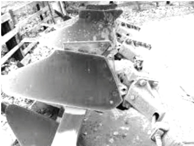
Рис. 2.4. Корпус плуга з паралелограмним перерізом скиби фірми «Huard»
