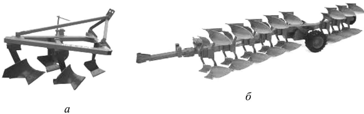
Рис. 1.1. Полицеві плуги: а –начіпний двокорпусний; б – причіпний восьмикорпусний
