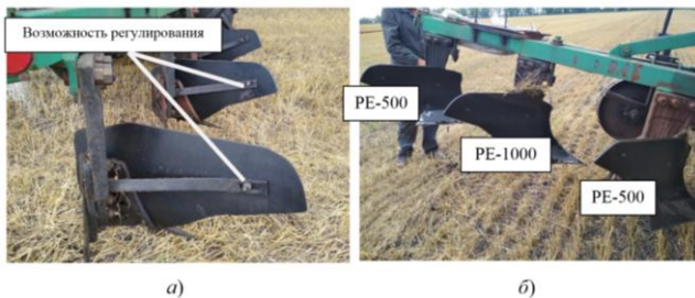
Рисунок 3 – Плуг, укомплектованный экспериментальными отвалами: а) конструкция позволяет регулировать угол наклона отвала; б) визуализация размещения отвалов по маркам.
