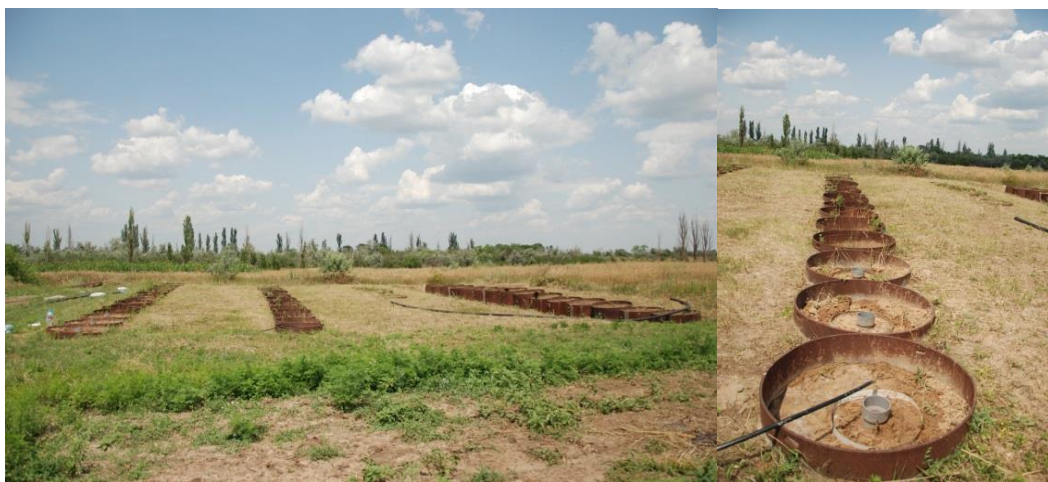
Рис. 1. Експериментальні лізіметри для визначення оптимальної стратиграфії техноземів на біоекологічному стаціонарі Дніпропетровського державного аграрно-екологічного університету (м. Покров, Дніпропетровська обл., Україна)
