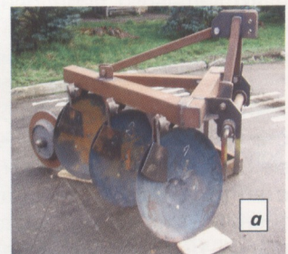
Рис. 3 – Польові дослідження V- подібного знаряддя на підкопуванні цибулевих культур у варіанті агрегування з мотоблоком
