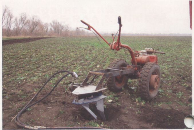
Рис. 3 – Польові дослідження V- подібного знаряддя на підкопуванні цибулевих культур у варіанті агрегування з мотоблоком
