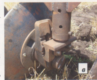
а- базовий варіант з сферичним суцільним диском; б - варіант комплектації вирізними дисками; в - механізм регулювання кутів постановки диска до напрямку руху і вертикалі. Рис. 4 – Загальний вид дискового плуга у двох варіантах комплектації
