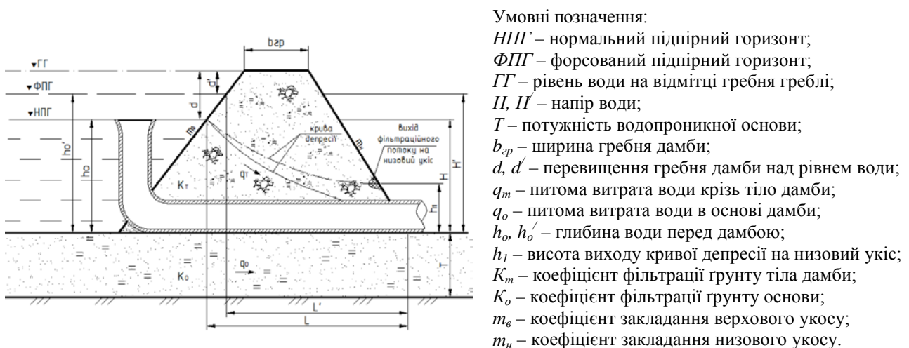
Рис. 1. Схема до розрахунку фільтраційних деформацій ґрунтової дамби (розроблено автором на основі [4])
