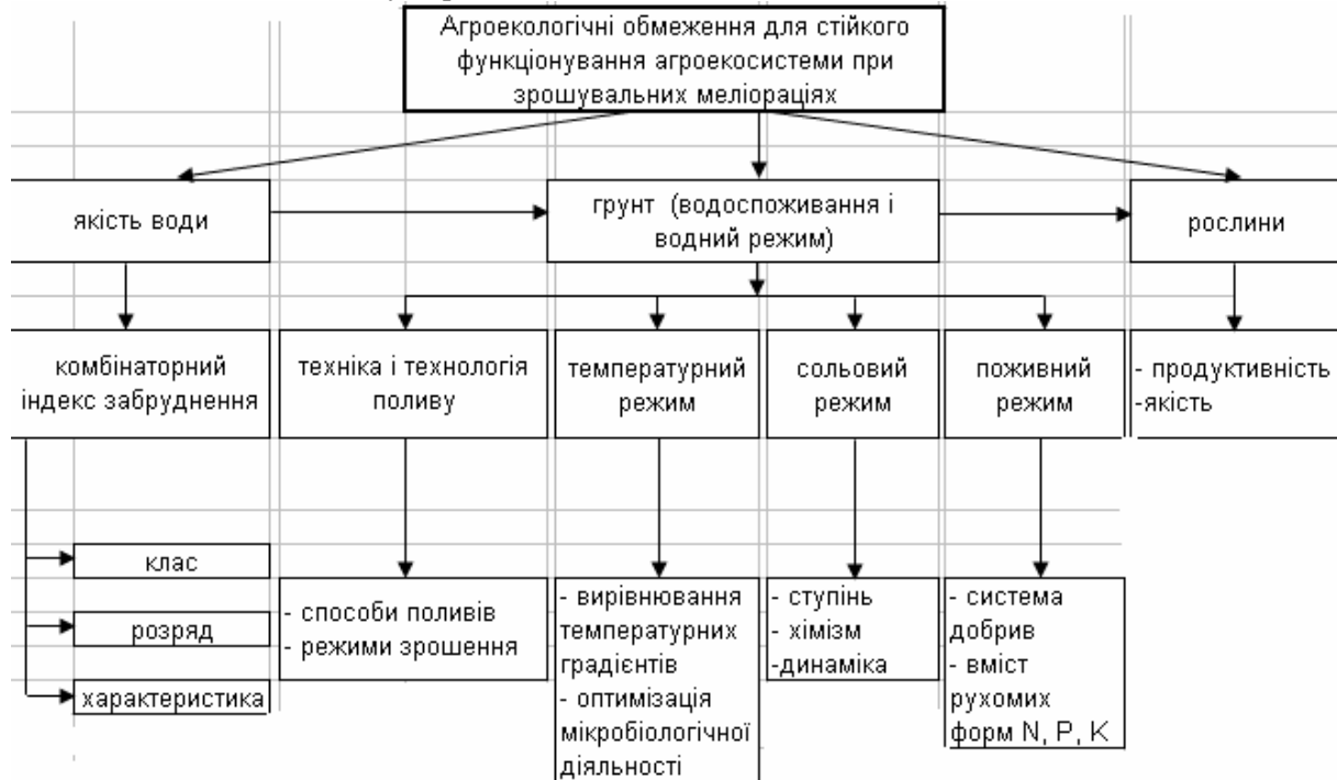
Рисунок - Блок-схема агроекологічних обмежень для стійкого функціонування агроecosистем при зрошувальних меліораціях
