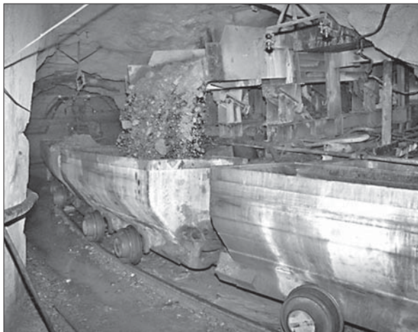
Рис. 1. Випуск уранової руди віброживильником ВПР-4М
