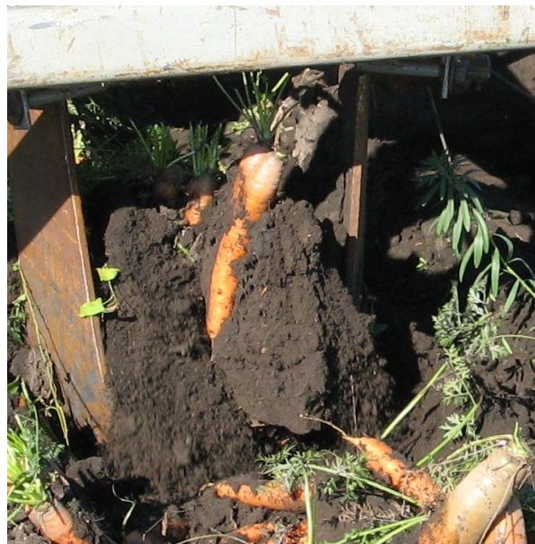
Рис. 3. Польові випробування викопування коренеплідів буряку та моркви пасивною скобою в господарствах Дніпропетровської області
