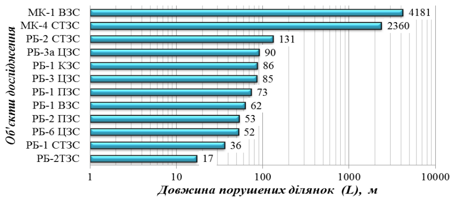
Рис. 6. Параметри порушених ділянок фільтрації води на різних спорудах (вісь абсцис представлена логарифмічною шкалою)
