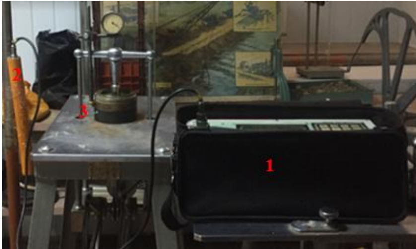
Рис. 1 Зовнішній вигляд приладу МІЕМП-14/4 (1) з вертикально розташованою приймаючою антеною (2) під час одночасної фіксації ЕМІ та навантаження зразка глини на одометрі (3)
