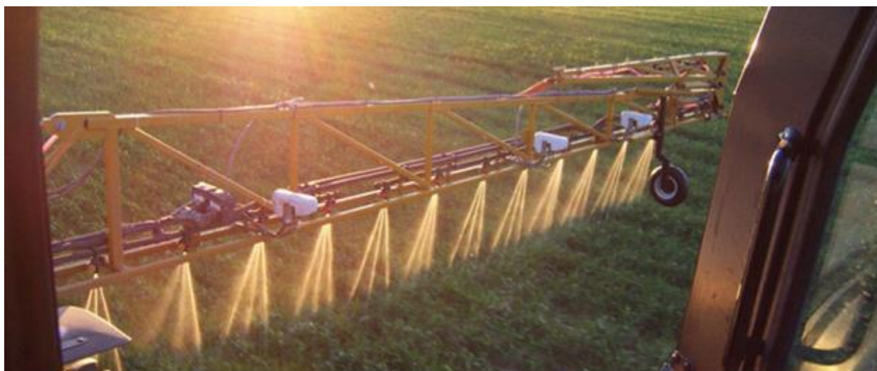
Рис. 41. Внесення КАС трьохструменевими розпилювачами з вертикальним рухом краплин робочого розчину
