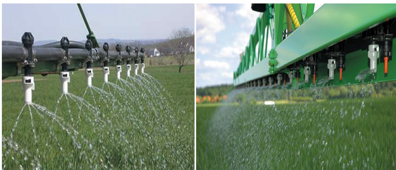
Рис. 37.Крупнокапельне внесення розчинів КАС (зліва - пятиструменеві розпилювачі FL; справа – дефлекторні розпилювачі FD)
