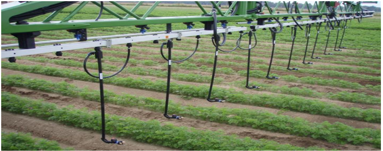
Рис. 46. Система Dropleg- підлисткове обприскування добривами і засобами захисту рослин є спільною розробкою компаній Amazone, Lechler та Syngenta.
