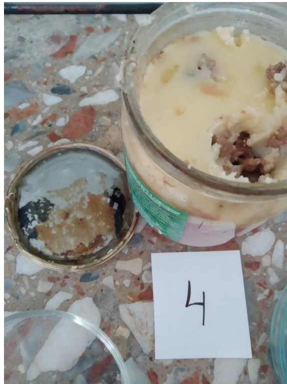
Рис. 9. Чорні плями та налиплий сухий уміст на внутрішній поверхні кришки консерви ТОВ «Агрофірма Столична»
