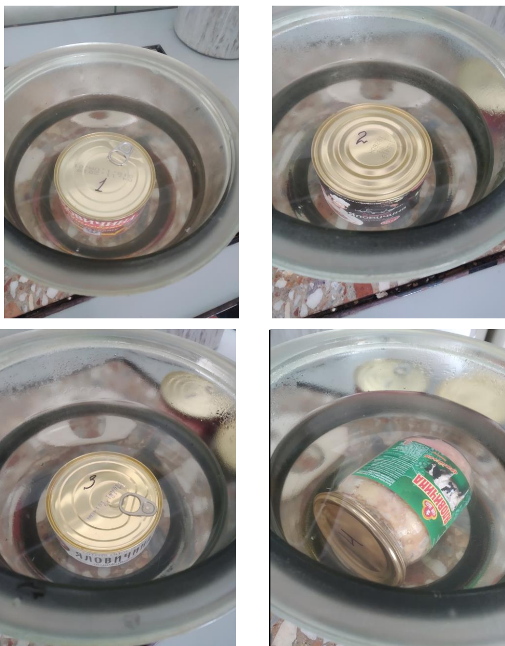
Рис. 16. Перевірка на герметичність у посудині з гарячою водою
