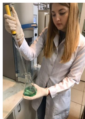
Рис. 16. Титрування у присутності фенолфталеїну.
