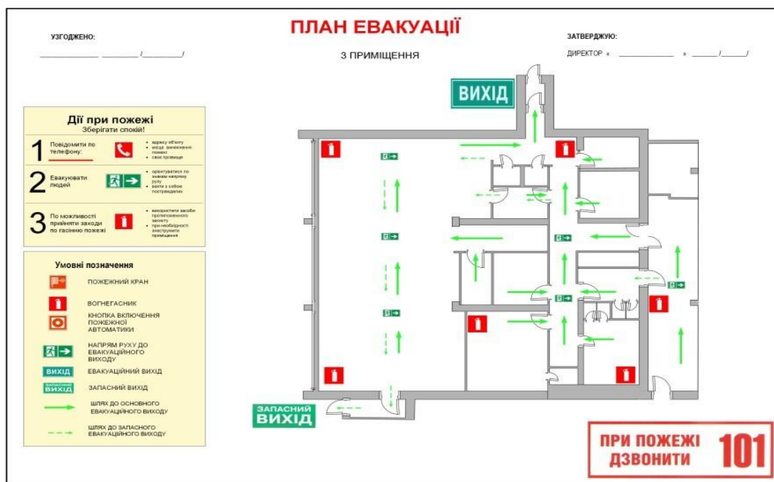
Рисунок 5.3 – План-схема евакуації в надзвичайній ситуації
