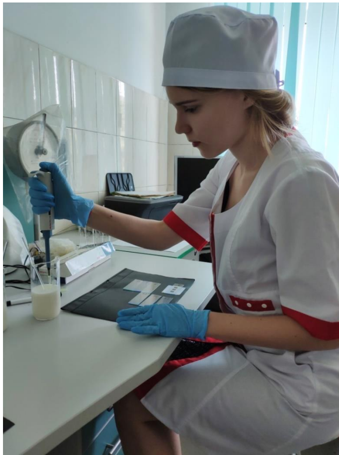
Рис. 2. Відбір проби молока за допомогою одноканального піпет-дозатора змінного об'єму
