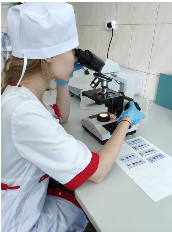
Рис. 7. Мікроскопія препарату. Підрахунок кількості соматичних клітин за методом Прескотта-Бріда
