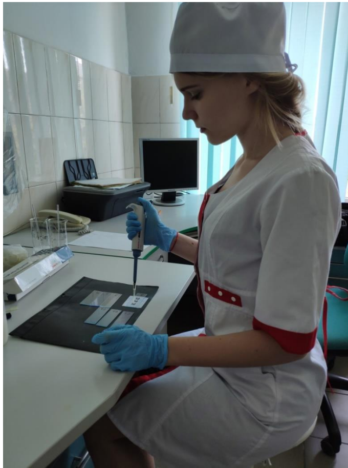
Рис. 3. Нанесення крапель молока на предметне скло за допомогою одноканального піпет-дозатора змінного об'єму
