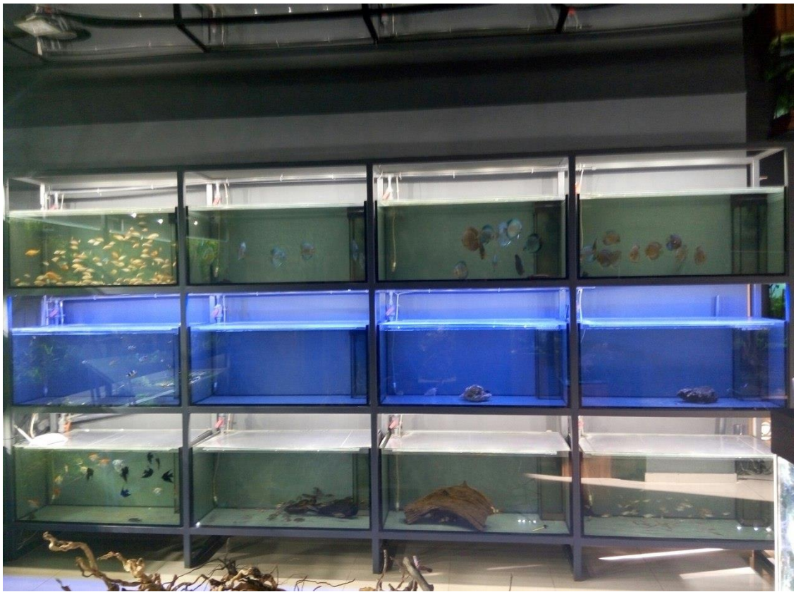
Рис. 5. Експериментальний полігон-стійка з 12 акваріумами (система фільтрації для прісних і морських акваріумів роздільна)
