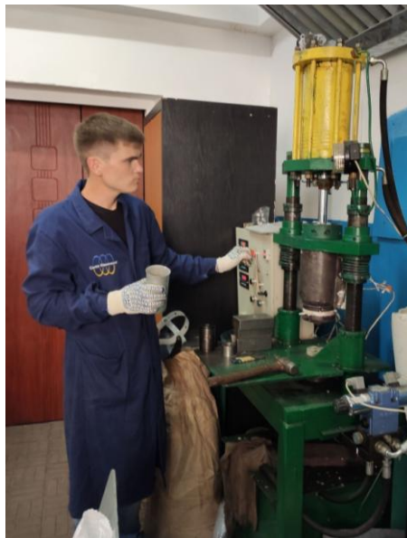
Рис. 3.6. Ливарна машина ручного типу ГШП для переробки гранул у вироби.
