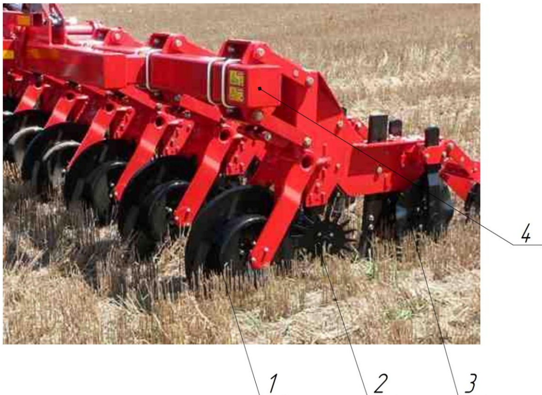
Рис. 1.4 – Культиватор Sun Flower 7600: 1 – розрізний диск; 2 – розпушувачий диск; 3 – вирізний диск; 4 – рама з паралелограмним механізмом.
