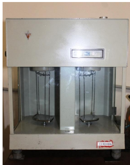
Рис. 3.3 Аналітичні терези ВЛР-200, на яких реалізовано гідростатичне зважування.
