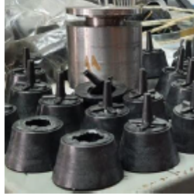
Рис.3. Экспериментальные заготовки из полученного графитопласта для детали 403к (John Deere-1895).
