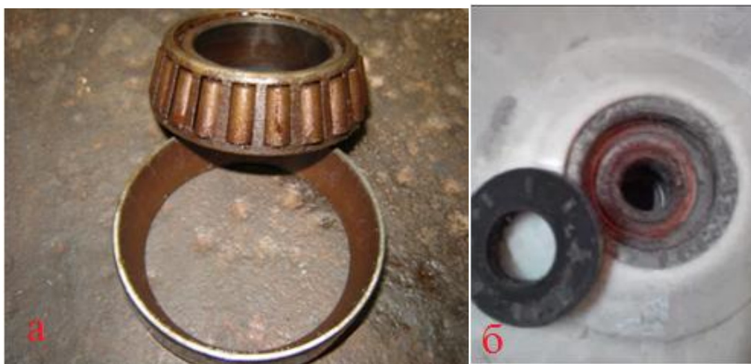
Рис.1.6 Стан підшипникових вузлів після сезону експлуатації без проведення консерваційних робіт. а- підшипник розрізного диску; б- підшипник загортаючого колеса.
