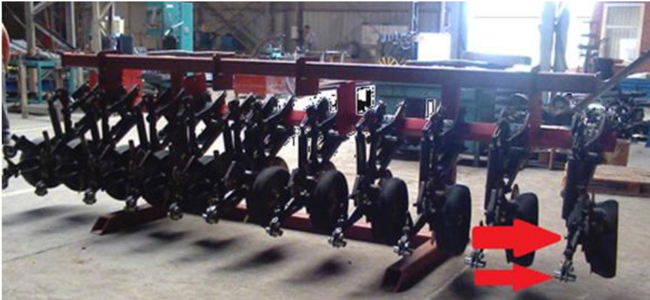
Секція посівного комплексу Turbosem II 19-60 встановлена на стапелі для подальшого демонтажу деталей
