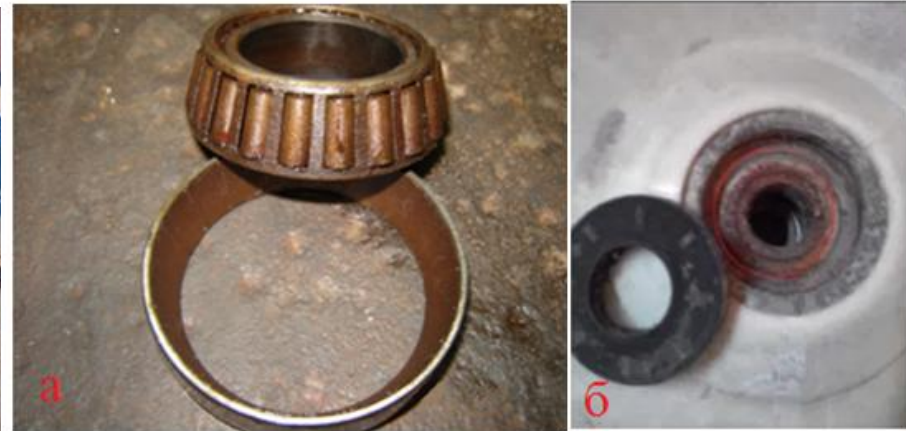
Стан підшипникових вузлів після сезону експлуатації без проведення консерваційних робіт.
