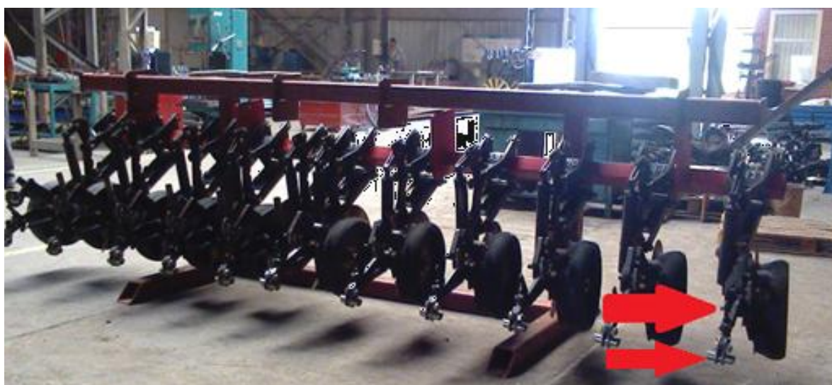
Рис.1.4. Секція посівного комплексу Turbosem II 19-60 встановлена на стапелі для подальшого демонтажу деталей.
